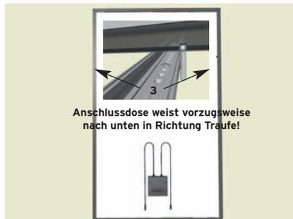
an der Rahmenunterseite der PV-Module (nur in der ersten PV-Modulreihe, Traufe zwingend erforderlich). Aufgrund des vertikalen Rastermaßes zwischen den Montageprofilen 400 (2) sollte sich ein Abstand von ca. 10 mm zwischen zwei Modulreihen einstellen.
