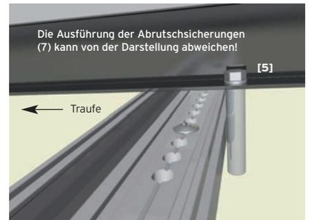
Bei einer horizontalen Anordnung der PV-Module (hier nicht dargestellt - siehe Langfassung) ändern sich lediglich die absoluten vertikalen Abstände der Montageprofile 400 (2) zueinander. Das Prinzip der Klemmung der Montageprofile bleibt unverändert.
